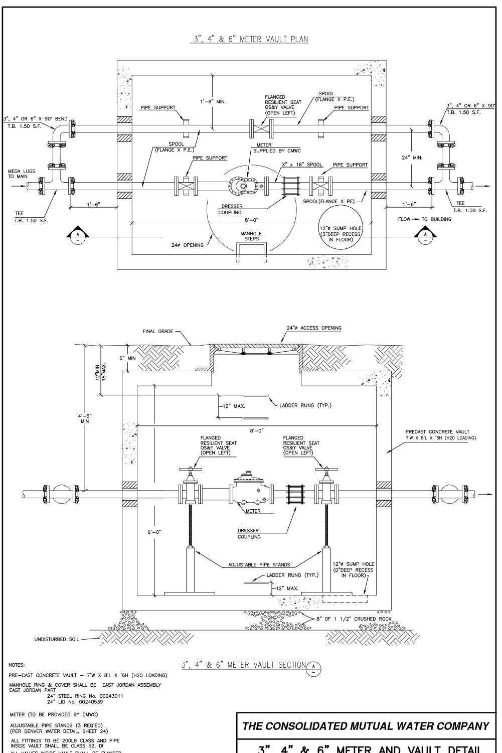
ALL VALVES INSIDE VAULT SHALL BE FLANGED OS&Y OPEN LEFT RESILIENT SEAT.
